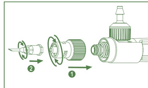
Luer-Lock-Ansatz anschrauben, Nadel befestigen.
