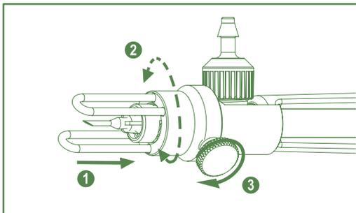
FishGuide™ aufstecken **1**, Position justieren **2**, Rändelschraube leicht anziehen **3**.
