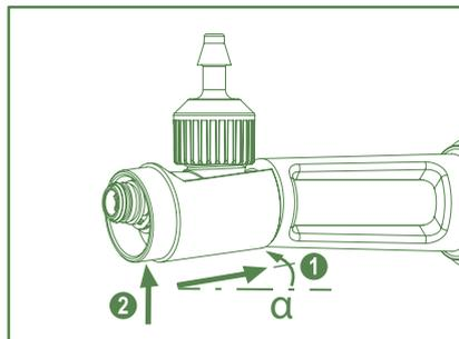
Schwarze Mantelung etwas winklig einführen **1** und bis zur Schnapp-Kupplung schieben **2**.
